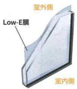
室内側のガラス面に Low-E 膜をコーティングした高断熱複層ガラス
